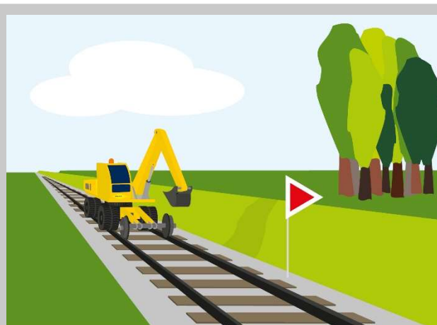
Wskaźnik kierunku zejścia z toru dla pracowników.
