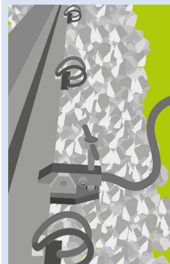
Rysunek zacisku uszynienia
